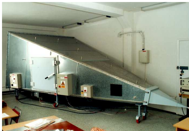
Figure 2. GTEM chamber in Laboratorium Urządzeń Elektronicznych Poznań
